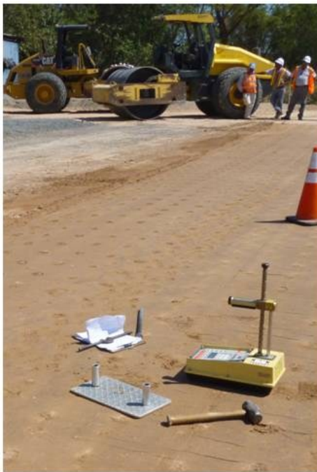
Figura 5-5. Método del densímetro nuclear (Fotografía: UTLA - Ensayos de Laboratorio de Suelos)
