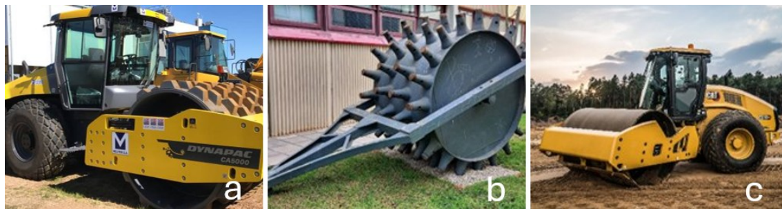
Figura 5-3. Equipos principales de compactación en presas de materiales sueltos: (a) rodillo pata de cabra tipo padfoot (autopropulsado); (b) rodillo pata de cabra tipo sheepsfoot de tiro (referencia conceptual); (c) rodillo vibratorio liso para materiales granulares.
