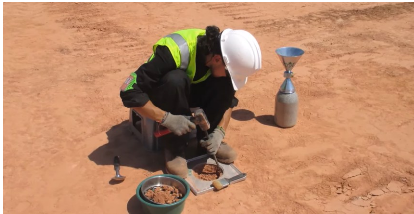
Figura 5-4. Método del cono de arena (Fotografía: Construreyes Ingeniería)
