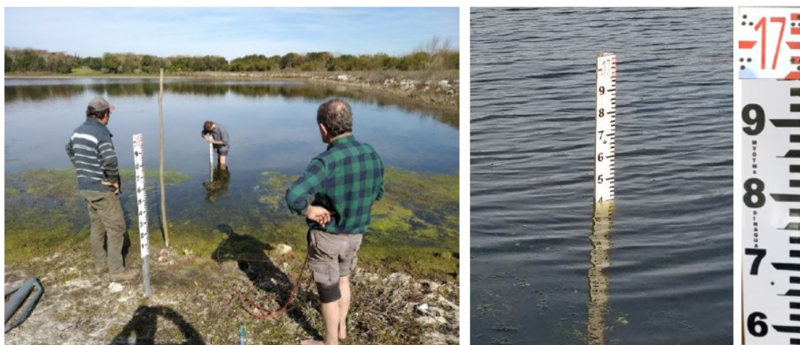
Figura D-1. Obsérvese la ubicación de las escalas en zona de baja pendiente, condición que reduce la precisión de la lectura y que se recomienda evitar en el diseño de la instalación
